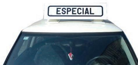
Sirve para indicar la circulación próxima de un vehículo en régimen de transporte especial.
