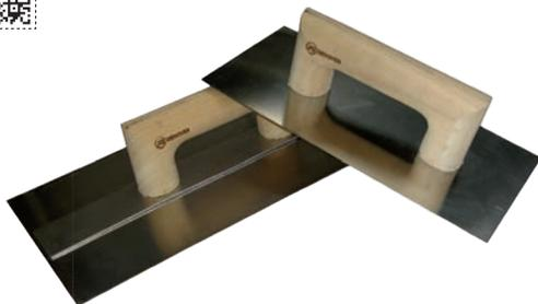
Se utiliza para extender e igualar los planos del mortero aplicado en enfoscados y revocos de paredes.
