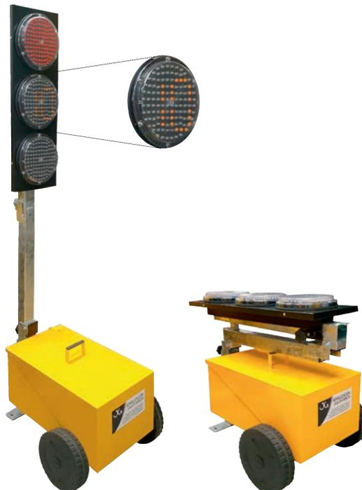
Sistema de semáforos formado por 2 semáforos con carro metálico portabaterías con ruedas, 3 luces Ø200 mm., central de cables de conexión y alimentación. En la lente ámbar dispone de un contador hacia atrás donde indica a los conductores el tiempo que les queda para que se ponga en rojo. Utiliza unidades de control QM3RD con diferentes posibilidades de fases y tiempos de ciclo del semáforo.
