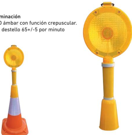
Diseñada para encajar en la mayoría de conos. Lente de color ámbar, con 6 Leds y más de 60 destellos por minuto, visible a más de 200 m. Cuenta con 200 horas de autonomía trabajando continuamente. Encendido y apagado automático mediante célula fotoeléctrica. Dispone de asa de plástico.
