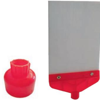
Preparados para ser instalados en los postes de poliuretano tipo PU. Los carteles se fijan a los mismos a través de las 2 perforaciones que disponen de Ø5 mm con un posterior enroscado al soporte. Ayuda a una mejor visualización de la obligación, prohibición o advertencia del peligro. Apropiado para una señalización rápida y elegante.
