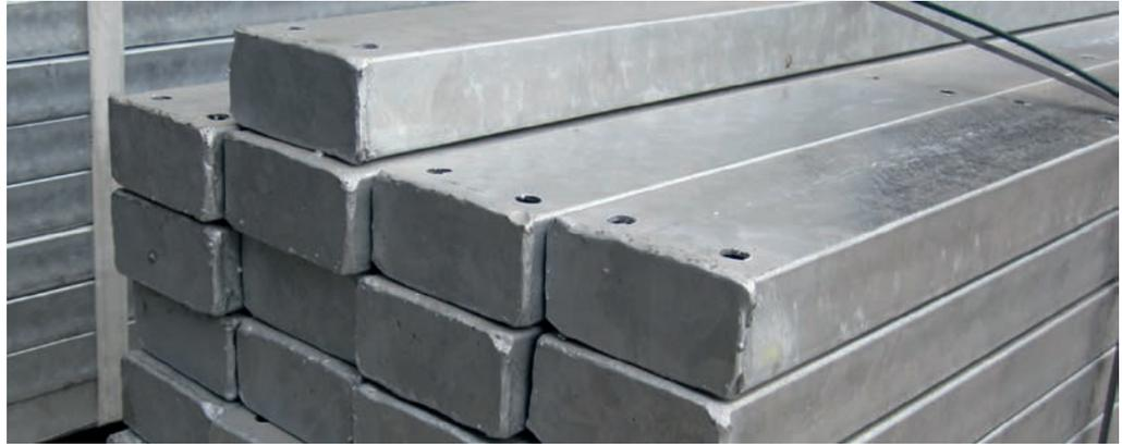
Fabricado en acero galvanizado en caliente, acero de calidad S235JR (UNE EN 10025-2), conforme a las normas UNE EN 12899-1 y UNE 135314 y acabado por inmersión según UNE EN ISO 1461, con tapa de acero soldada en todo el perímetro. Disponible sólo con las 2 perforaciones superiores y en diferentes medidas, alturas y espesores.
