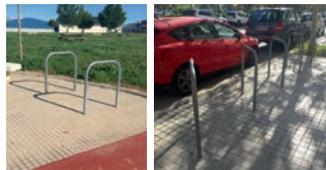
Fabricado en perfil circular de acero galvanizado. También se puede utilizar como aparcabicicletas.
