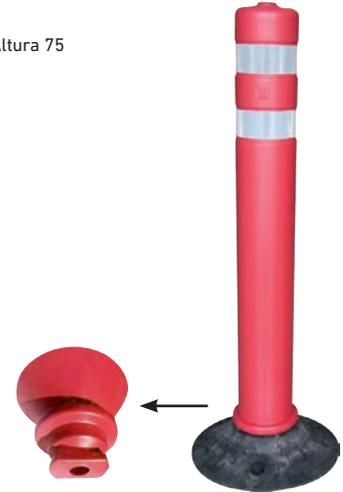
Baliza desmontable con 2 bandas reflectantes, base de caucho con hendiduras para el fácil anclaje con tornillos. Permite retirar el poste permaneciendo la base fija. Con 2 bandas reflectantes blancas.
