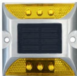
Captafaros de alimentación solar. 3 leds por cada lado. Impermeabilidad IP68. Dos caras ámbar intermitentes. No soporta el paso de los vehículos por encima.
