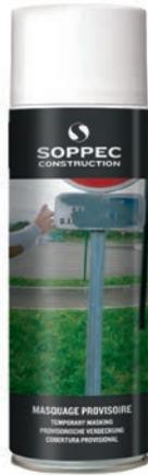
Spray para ocultar, provisionalmente, las señales de tráfico. Producto hidrófobo, resistente a la intemperie. Eliminación rápida, en soportes lisos, con un paño seco. Cubrimiento por bote de 5 m<sup>2</sup>. Secado en 10-15 minutos.
