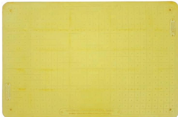
Fabricadas en composite reforzado con fibra de vidrio, con las esquinas redondeadas y la superficie antideslizante. Diseñado para obras de calles. De color amarillo y con resistencia a 2000 kg. de peso bruto del vehículo (500 kg. por rueda). Conforme a la normativa británica "DETR Safety at Street Works and Road Works Code of Practice".
