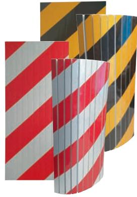
Protección con buen adhesivo para paredes rectas o curvas, fabricada en FOAM, material que permite ser amoldado o adaptado fácilmente. Viene provisto de un auto adhesivo que permite una fácil colocación. Dispone de una lámina reflectante N1 en color Amarillo/Negro o Rojo/Blanco en su cara externa. Esta plancha minimiza golpes y arañazos. Muy usados en parkings y garajes, industrias, centros deportivos, rampas de estacionamientos, etc.
