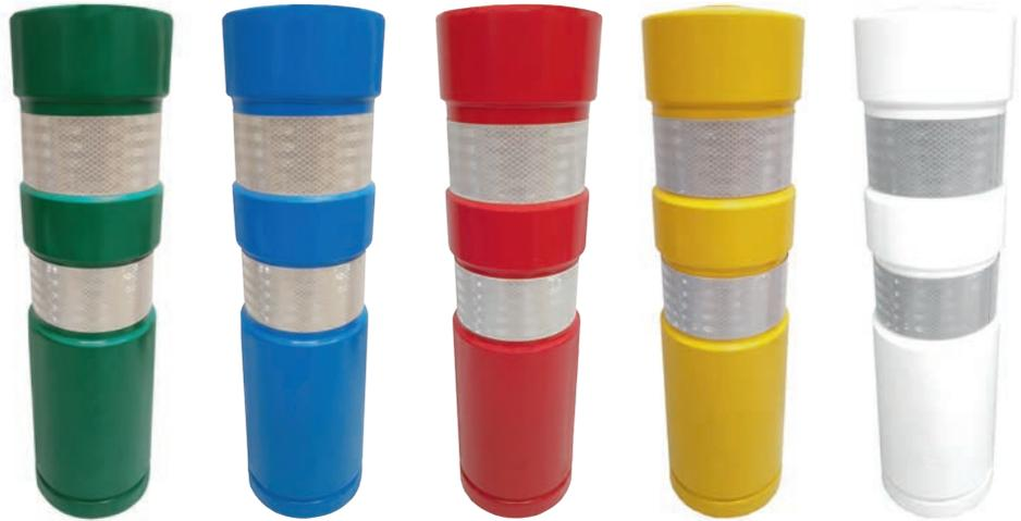
Fabricado conforme con la Norma UNE 135.363. Equipado con 2 bandas Reflex N2 de acuerdo con la Norma UNE 135.334 y con la Norma Europea EN 471. Anclaje interno fabricado en chapa galvanizada de Ø85mm. Incluye tornillería de M12x100mm con su taco estándar. Diseño especial de baliza para proteger su valor de retrorreflectancia de las inclemencias meteorológicas.
