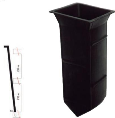
Se utiliza para crear un registro en el forjado que permite la colocación de la horca o pescante que sujetan las redes de seguridad. Su base (de 82x82) se introduce en el forjado y su diseño permite liberar los forjados superiores evitando que la horca se separe excesivamente de los mismos. Es una alternativa a los sistemas tradicionales cuyas horcas excesivamente inclinadas, demasiado separadas o exageradamente rectas, pueden dificultar el montaje de los mismos obligando incluso a perforarlos.
