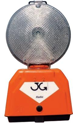
Balizas luminosas de un led, con un diseño innovador de la óptica que permite una alta luminosidad con un reducido consumo. En la parte superior de la lente, se encuentra un gancho de forma triangular, y en su parte trasera incluye un soporte metálico universal. La lente de la baliza puede rotar 360°, lo que le confiere una gran versatilidad dependiendo del uso. Con la compra de 5 uds de nuestra baliza se puede formar una cascada simple en la que se sincronizan por radiofrecuencia.
